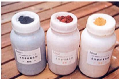
漆くいホタテ貝の貝殻を粉末にしたのが主な材料。もともとが多孔質の貝殻の性質を活かすために、少々泡めの粉のものを使っている。水を加えてエキサーで溶ぜる。このとき、同じく天然素材の顔料を溶ぜ込んで色をつける。左・黒は炭、赤は紅丹、黄色は黄鉄土がそれぞれ原料。分量は、お客様の好みを開き出ししながら、職人さんが技術を發揮する。溶ぜ合わせた材料を薄ら撒かせるために少し練り置きしてから、コテ舟に取ってコテで塗っていく。
